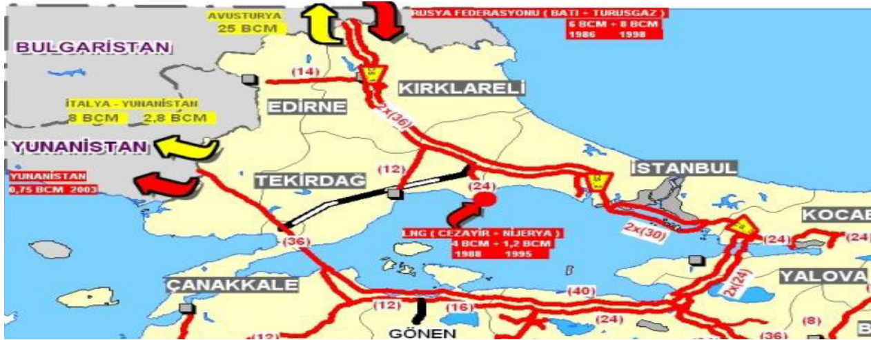
Şekil 12: Tekirdağ'dan Geçen Doğalgaz Boru Hatları
