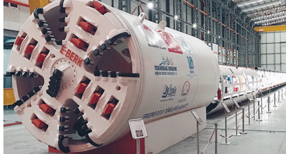
Şekil 17: Kazılarda kullanılan tünel açma makinesi
